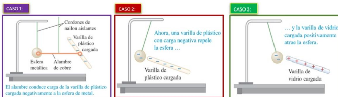
Figure 5.4: Electrificación por contacto.
