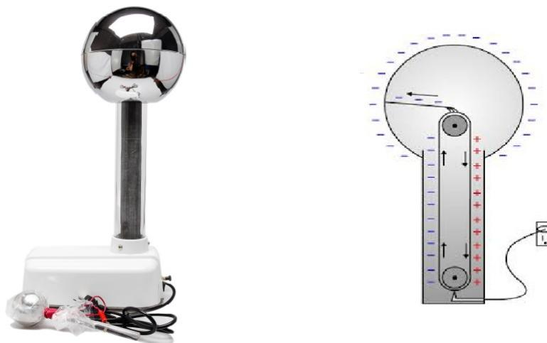
Figure 2.3: Generador de Van De Graaff y funcionamiento
