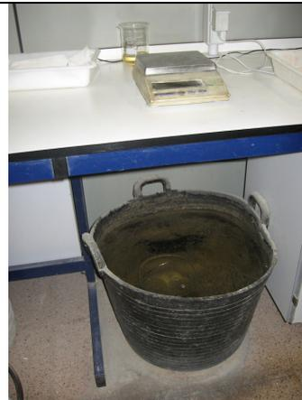
Dispositivo de pesada hidrostática
